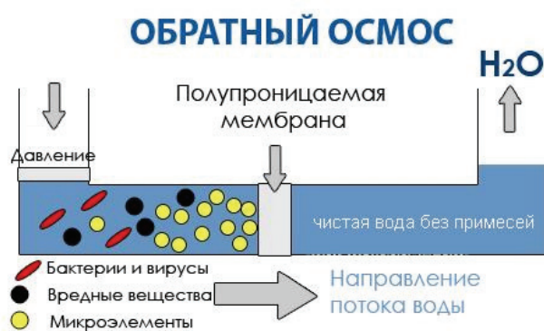
Рисунок 17 – Схема очистки воды методом обратного осмоса
